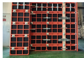
► 钢框木模实物
